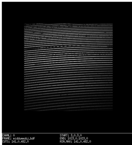
Создаем каталог спектров плоского поля. Также усредняем все кадры с помощью медианной фильтрации.
